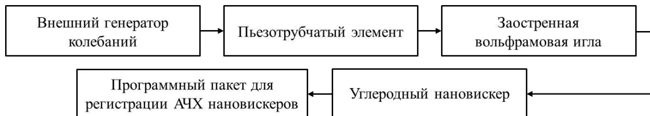
Рисунок 2.5. Общая схема возбуждения колебаний в НМР
