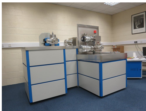
Рис. 7. Внешний вид магнитного масс-спектрометра для высокотемпературных термодинамических исследований с эффузионной камерой Кнудсена фирмы Mass Spectrometry Instruments Ltd., Великобритания [64].
