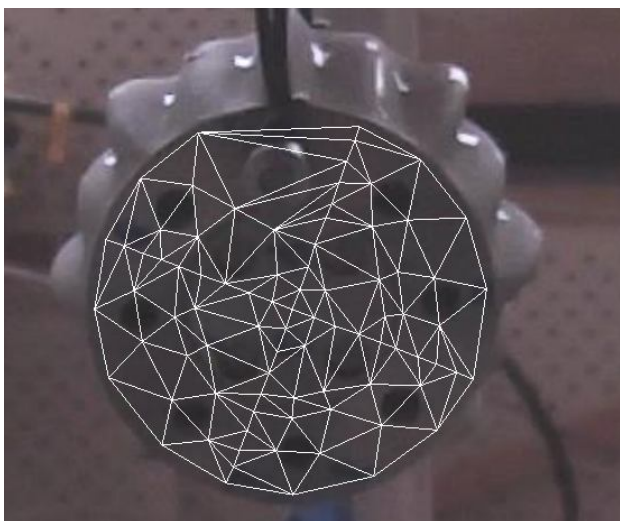
Рис. 5. Сетка контрольных точек для фиксации смещений поверхностей торцевого фланца 3D НЧИ
