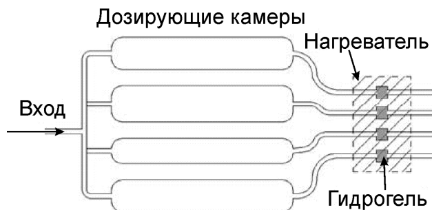
Рис. 22. Схема делителя потока с гелевыми клапанами [51]
