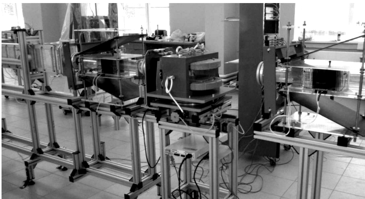
Рис. П2. Узел образца с электромагнитом рефлектометра поляризованных нейтронов РПН
