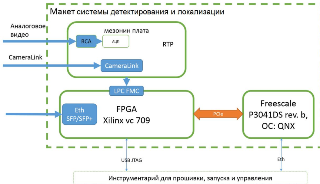
Рис. 2. Структурная схема макета системы детектирования и локализации
