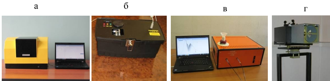
Рис. 4. Выпускаемые фурье-спектрометры: АФ-3 (а), ПАК-Б (б), ФСВ (в), ФСР-03 (г)
