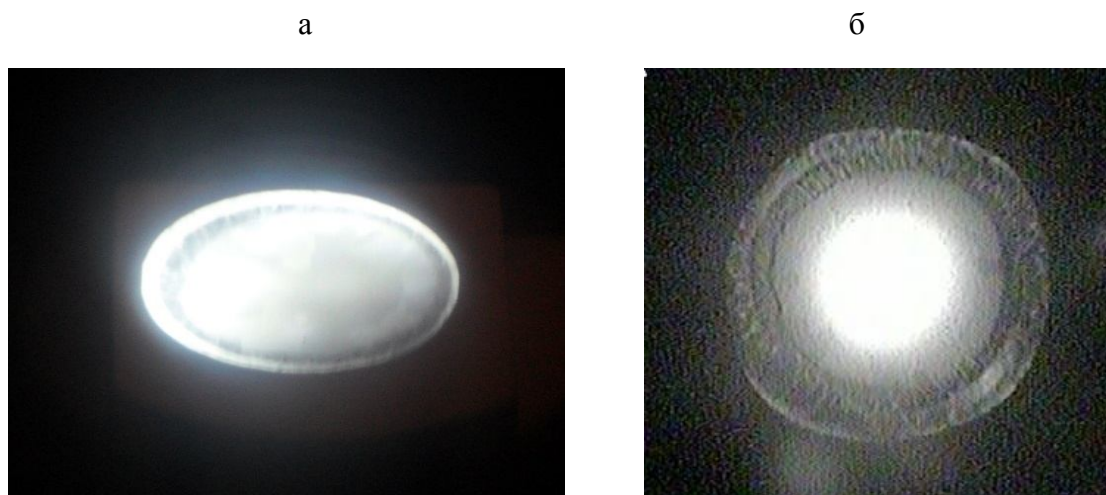
Рис. 6. Электронное изображение области эмиссии электронов с катода. а — прямонакальный катод без водяного охлаждения катодного узла, б — лазерный подогрев катода с водяным охлаждением катодного узла
