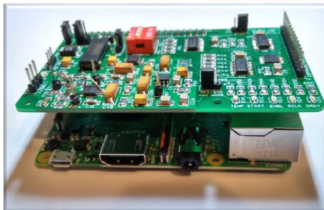
Рис. П2. Сборка платы АЦП и управляющего микрокомпьютера Raspberry Pi
