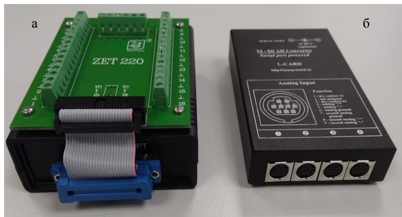
Рис. 1. Отечественные внешние модули АЦП: ZET-220 (а) и E-24 (б)
