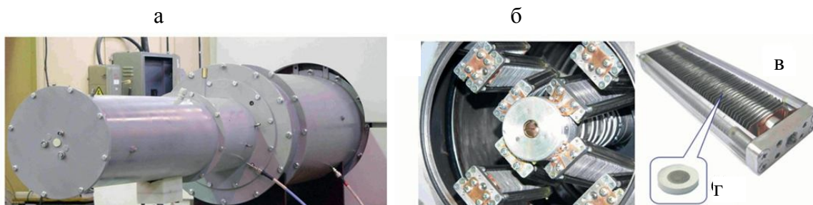
Рис. 2. Внешний вид узлов наносекундного твердотельного генератора S-500. Выходной узел генератора S-500 (а); узел SOS-диода (б); SOS-диод (в) и элементарный SOS-диод внутри сборки (г)
