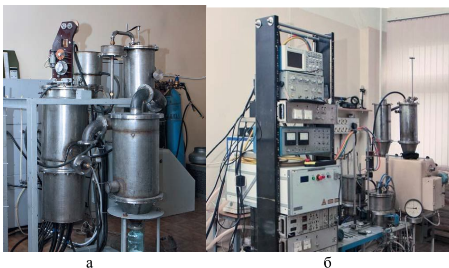
Рис. 4. Внешний вид установок для синтеза нанопорошков методами электрического взрыва проволоки (а) и лазерного испарения мишени (б)
