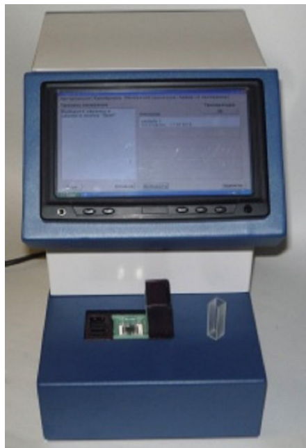
Рис. 1. Экспериментальный образец автоматизированного компактного дихрометра (СКД-4МУФ) биосенсорной аналитической системы
