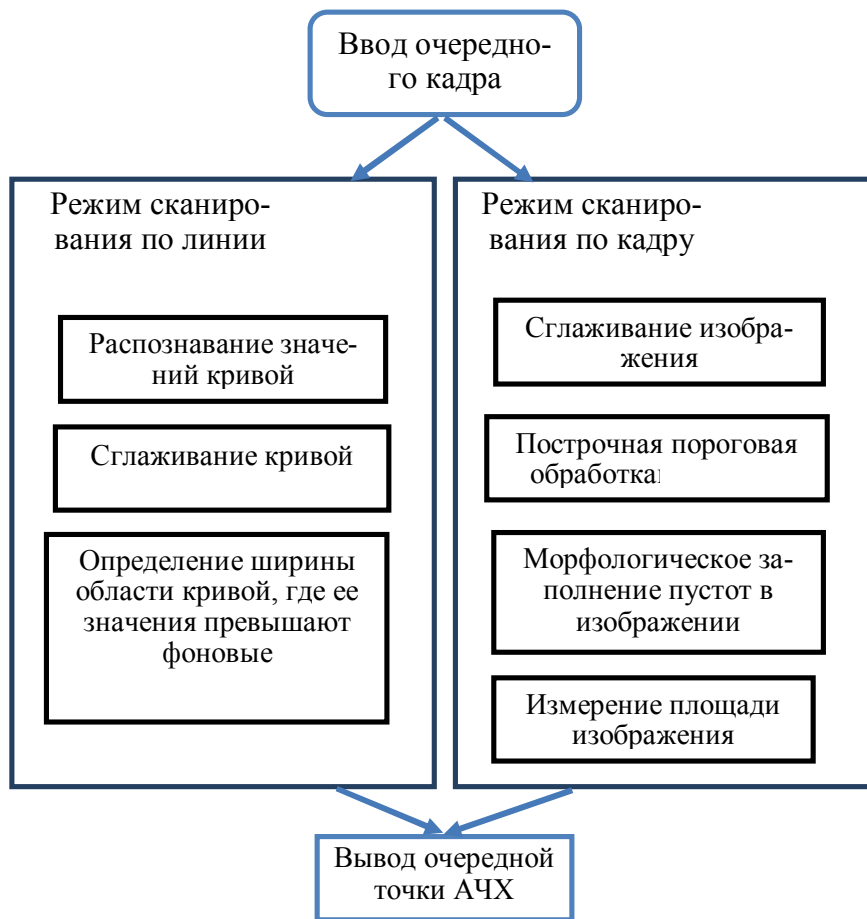
Рис. 3. Блок-схема алгоритма построения АЧХ НМО при его визуализации в СЭМ
