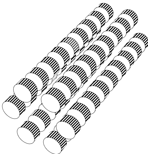
Рис. 18. Пример разрезных электродов (дисков), имеющих круговые сечения и служащих для создания в канале для перемещения заряженных частиц высокочастотного электрического поля с требуемым распределением псевдопотенциала вдоль оси устройства, содержащего высшие мультипольные компоненты
