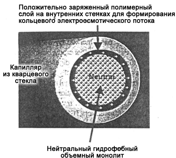
Рис. 7. Многослойная структура монолитной колонки с кольцевым электроосмотическим потоком
