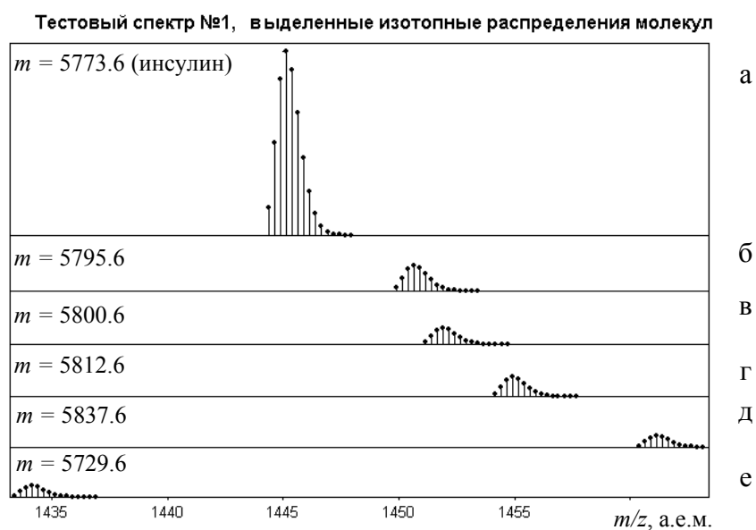
Рис. 9. Результат декомпозиции экспериментального масс-спектра инсулина с примесью грамицидина. Выделенные изотопные распределения молекул
