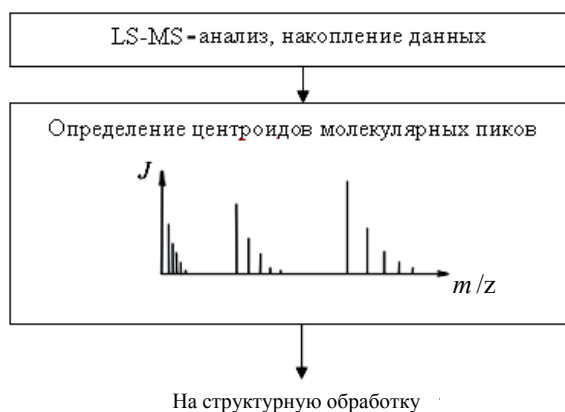
Рис. 1. Схема обработки результатов LS-MS-эксперимента. Предварительная обработка масс-спектра
