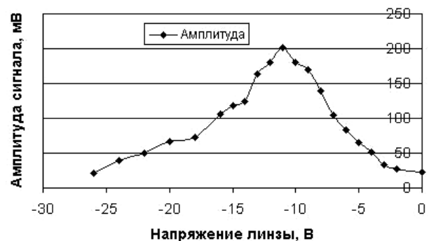
Рис. 16. Зависимость амплитуды сигнала на выходе анализатора от величины линзового напряжения
