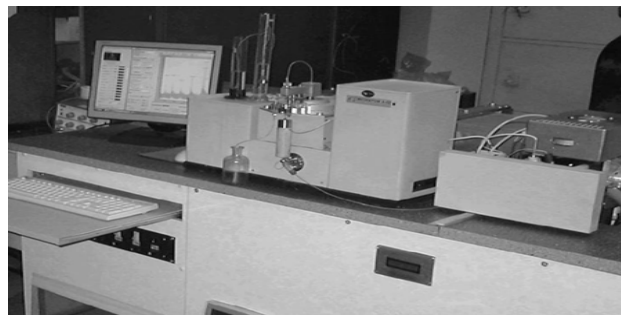
Рис. 6. Тандем: жидкостной хроматограф МилиХром А-02 с времяпролетным масс-спектрометром с ортогональным вводом и ионизацией электрораспылением (MX5303)
