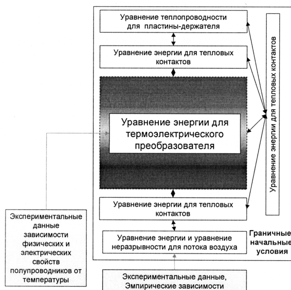
Рис. 2. Графическое представление математической модели расчета теплового блока амплификатора
