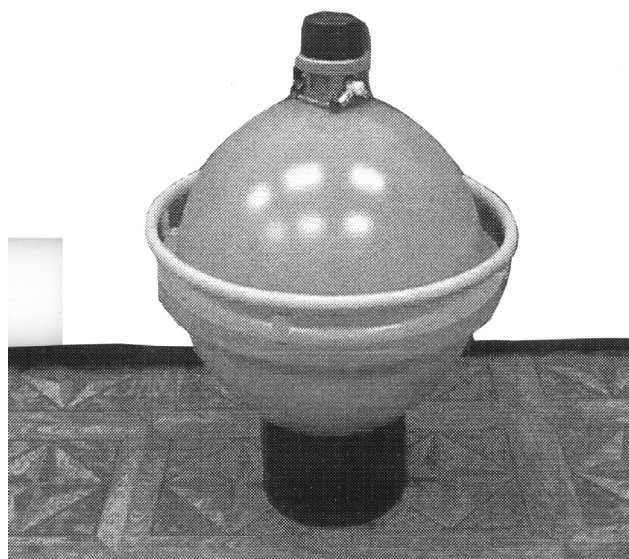
Рис. 2. Внешний вид самовсплывающей сеймостанции АДСС-1
