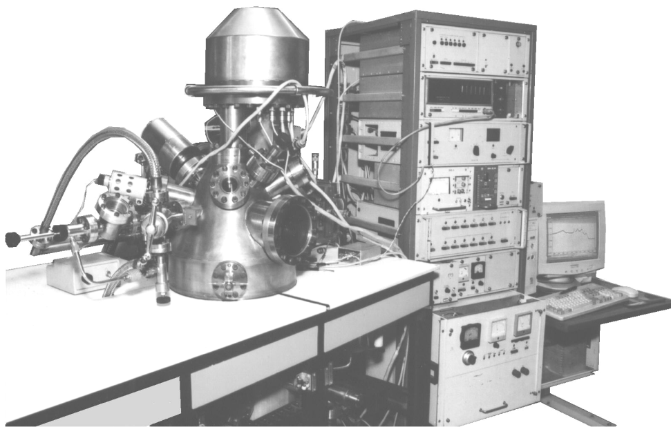
Рис. 3. Экспериментальный образец рентгеноэлектронного спектрометра для экспрессного химического анализа
