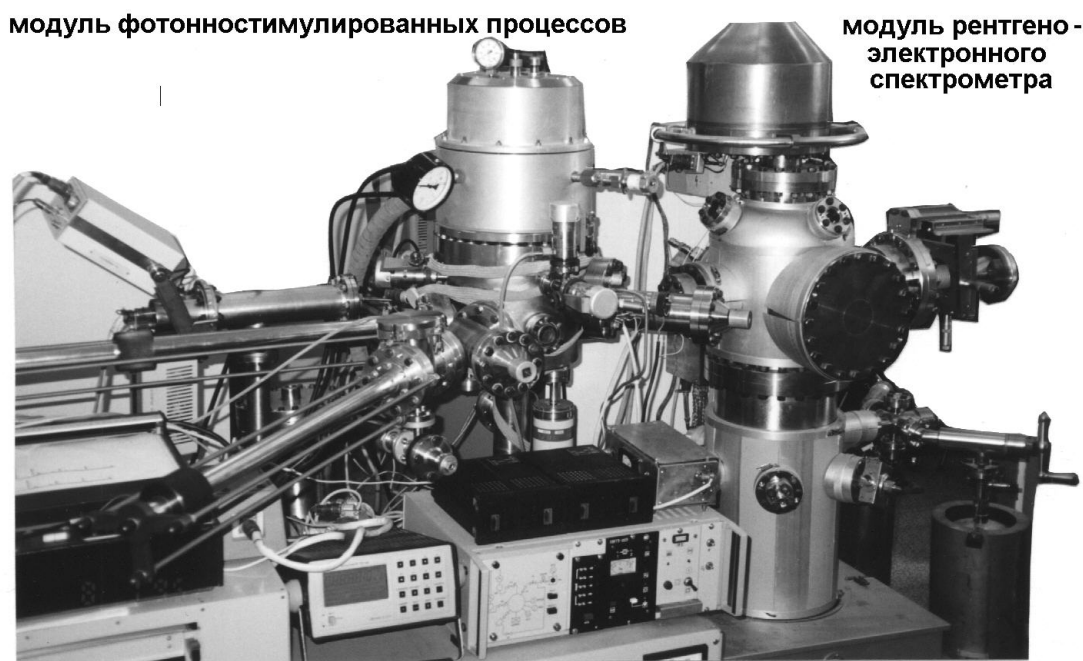
Рис. 2. Станция радиационностимулированных процессов с диагностическим модулем рентгеноэлектронной спектроскопии
