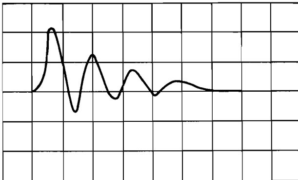
Рис.3. Осциллограмма тока ГИТ в режиме короткого замыкания. Масштаб по горизонтали - 5 мкс/дел.
