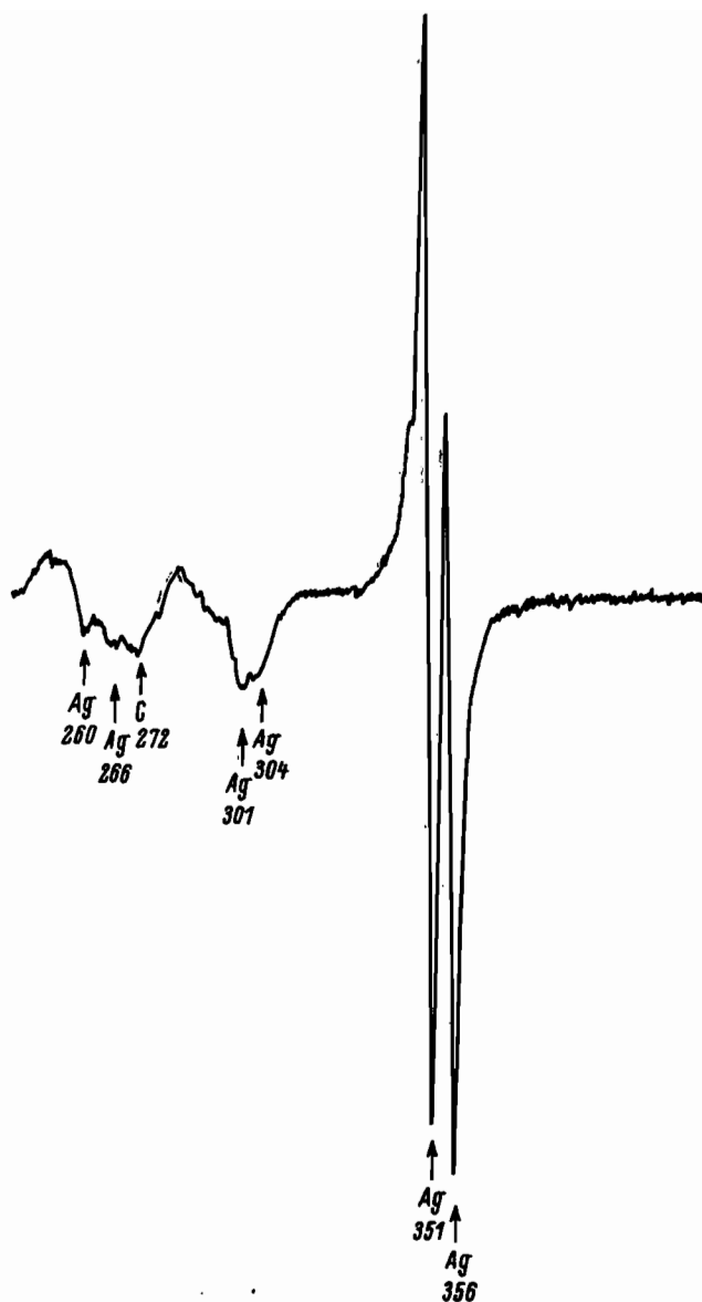
Рис.4. Спектр Оже-электронов серебра.
