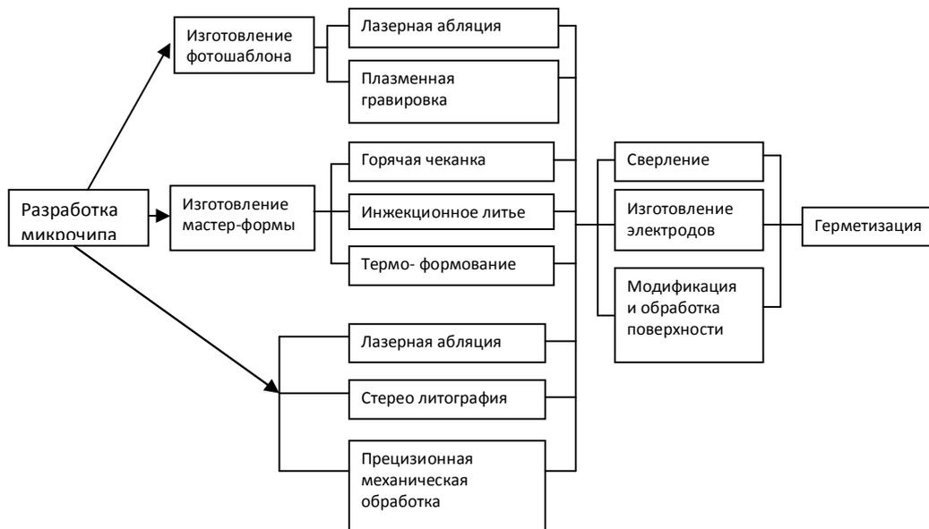
Рисунок 1.2 Основные стадии и процессы изготовления микрочипов из полимерных материалов.
