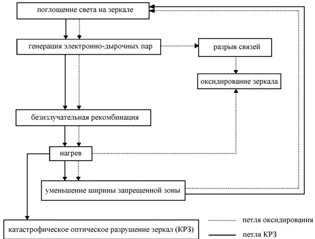
Рисунок 1.10 - Схема процессов, приводящих к катастрофическому оптическому разрушению зеркал лазерного диода [29].
