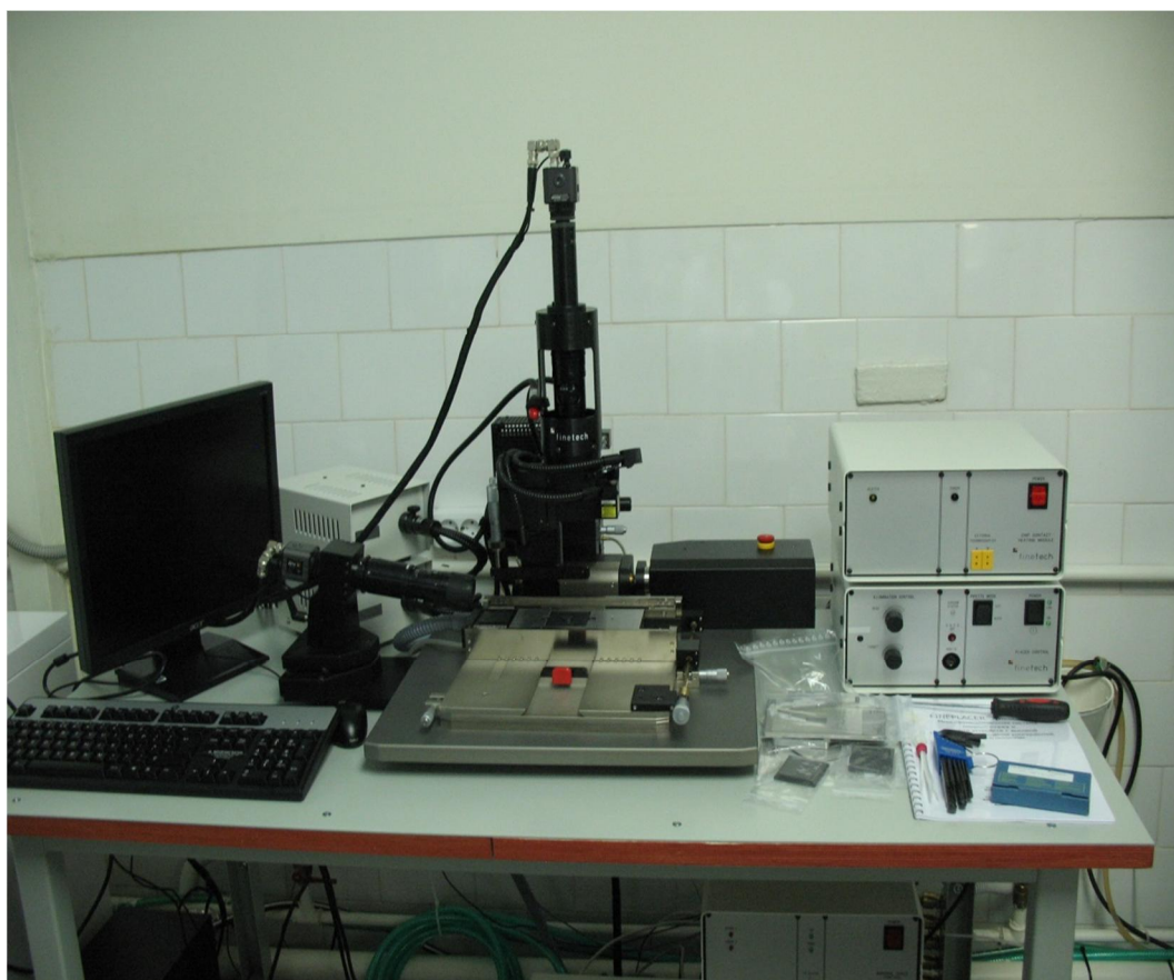
Рисунок 5.1 - Фотография установки бесфлюсовой пайки лазерного чипа на теплоотвод
