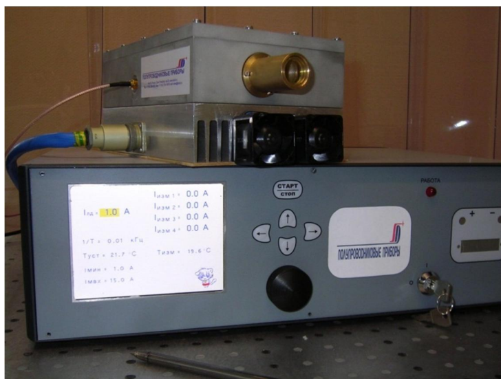
Рисунок 6.3 - Внешний вид ТТЛ для технологических применений с блоком питания
