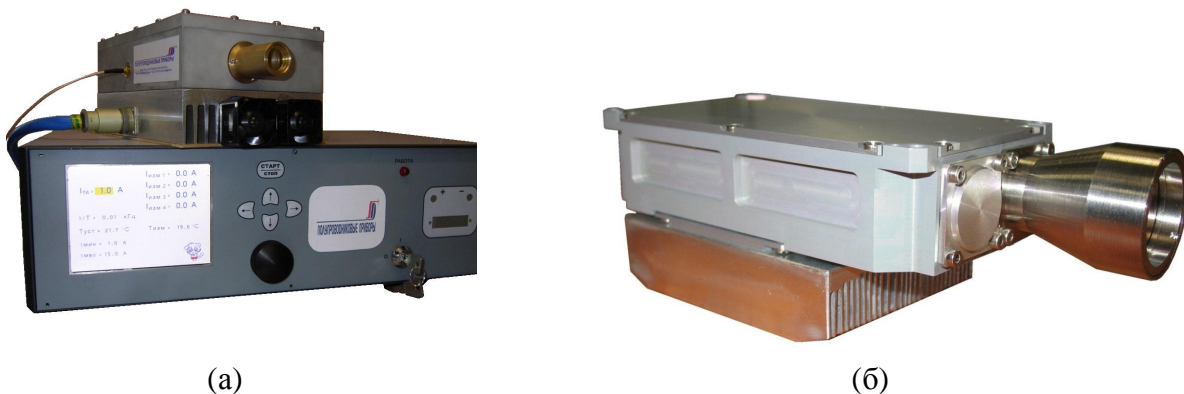
Рисунок 14 (а) - Внешний вид ТТЛ для технологических применений с блоком питания, (б) – Внешний вид ТТЛ для дальномеров, работающий в безопасном для глаз диапазоне спектра.
