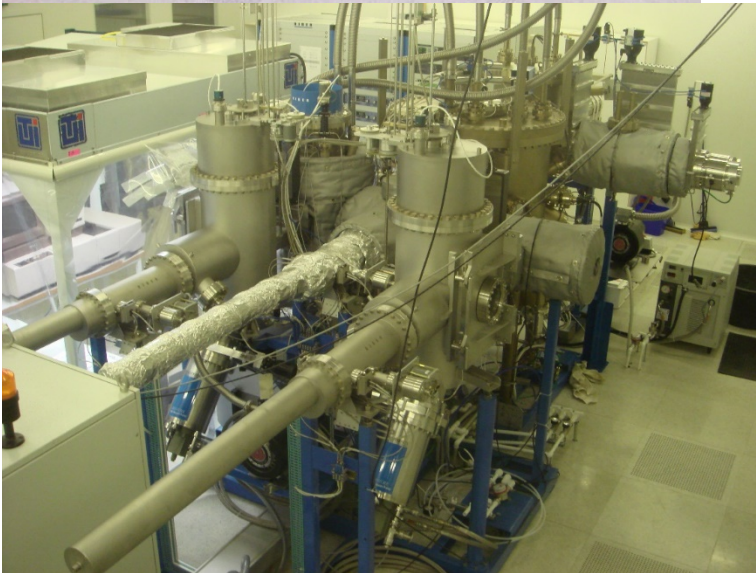
Рисунок 2.1. Внешний вид установок молекулярно-пучковой эпитаксии: Veeco GenIII (вверху), Riber MBE 49 (внизу).
