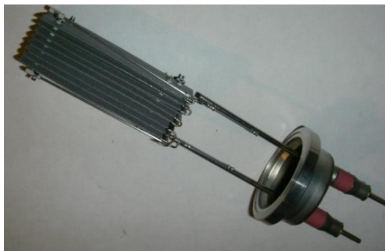
Рисунок 2.10 – Внешний вид сборки нераспыляемого геттерного насоса (НГН) на фланце CF35
