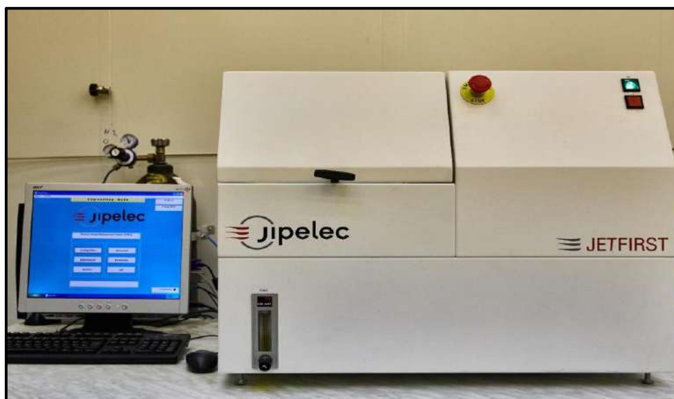
Рисунок 2.4 – Фотография установки быстрого термического отжига Jipelec Jetfirst 100
