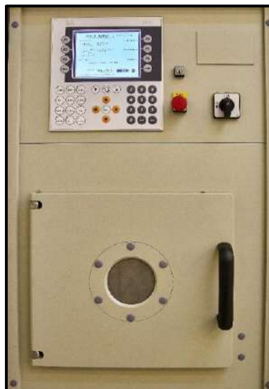
Рисунок 2.3 – Фотография лицевой панели установки плазменной очистки PiNK Plasma system V15-G
