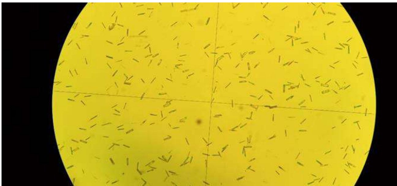
Рисунок 4.2 – Оптический снимок перенесенных GaN ННК на подложку-носитель
