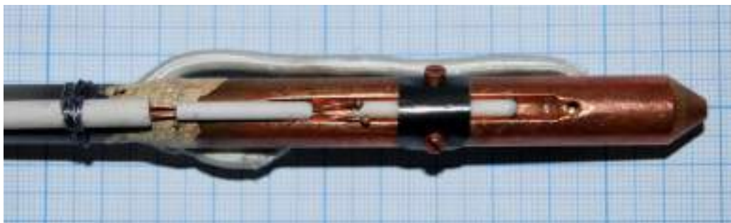
Рисунок 3.15 – Внешний вид держателя образца со стороны монтажа платинового чувствительного элемента ЧЭП-2888 (ГОСТ 6651-2009)
