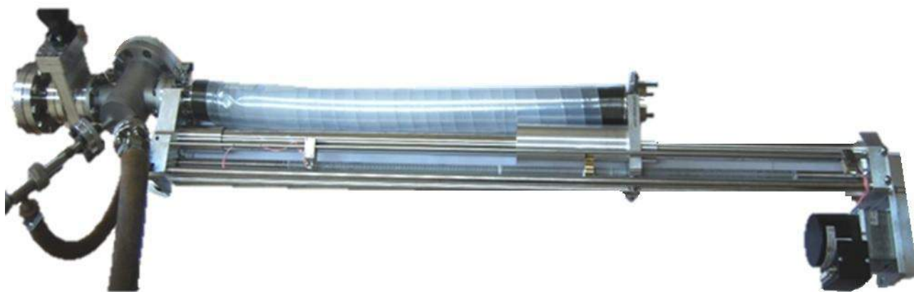
Рисунок 3.11 – Внешний вид системы трансляции в сборе с высоковакуумным шиберным затвором и шлюзовой камерой
