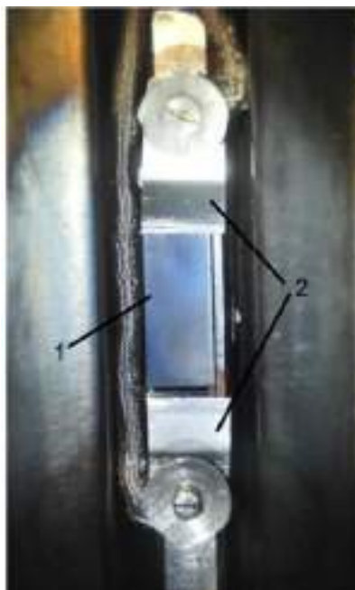
Рисунок 4.5 – Фотография структуры Fe/SiO 2 (25.3 нм)/Si(100) на держателе образца в технологической сверхвысоковакуумной камере:
