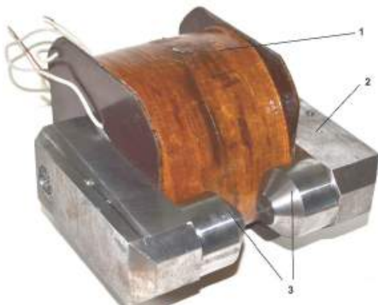
Рисунок 3.7 – Электромагнит с магнитопроводом:
