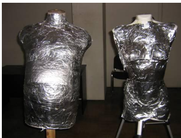
Рисунок 2.4. Использованные макеты человеческих тел, обернутые в фольгу для создания рассеивающих свойств
