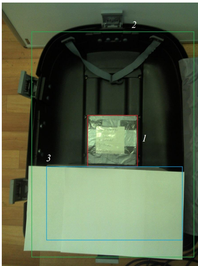
Рисунок 3.15. Расположения исследуемого диэлектрика внутри оболочки. 1 – исследуемый диэлектрик (ПВХ), 2 – оболочка (чемодан), 3 – прозрачная для СВЧ диапазона подложка.
