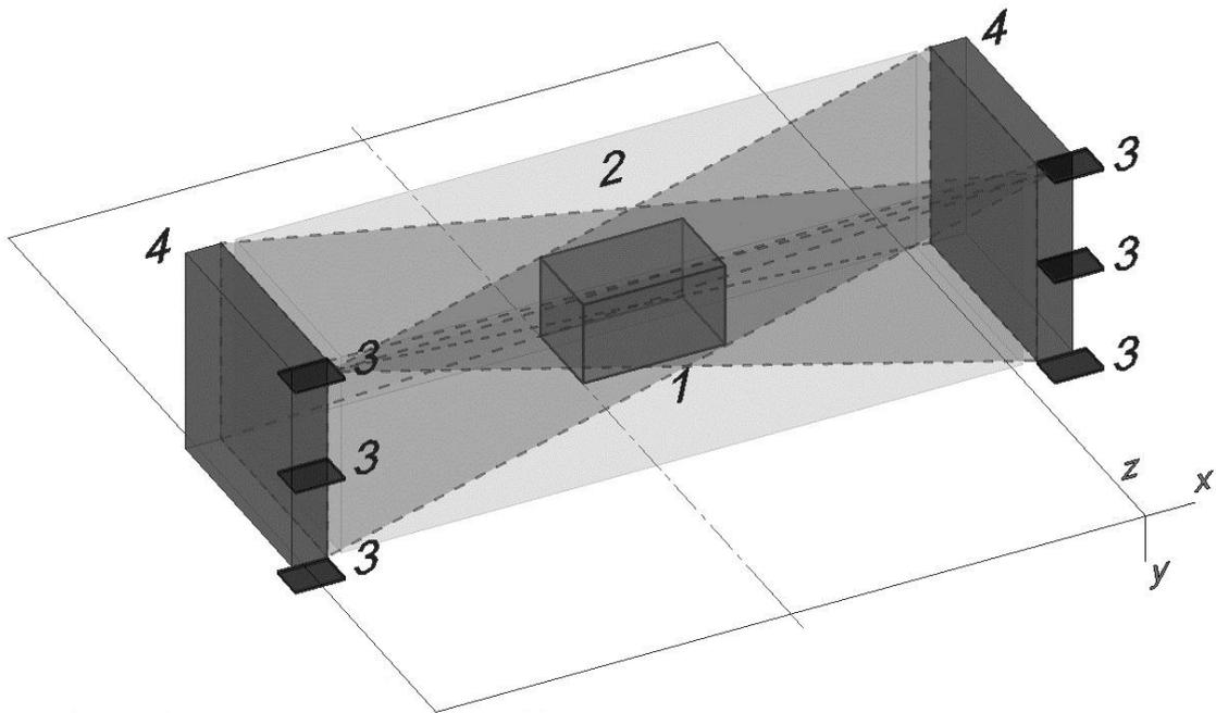
Рисунок 7. Экспериментальная установка для построения движущихся диэлектрических объектов в избранной системе координат. 1 – исследуемый диэлектрик, 2 – исследуемая зона, 3 – 6 приемных антенн, 4 – 2 РСА передатчиков. Пунктиром отмечены 2 пары приемная антенна, РСА, образующие профиль удлинения.
