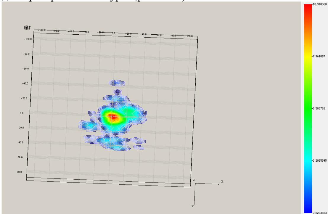
Рисунок 2. Радиолографическое изображение человека, восстановленное с использованием преобразования Фурье
