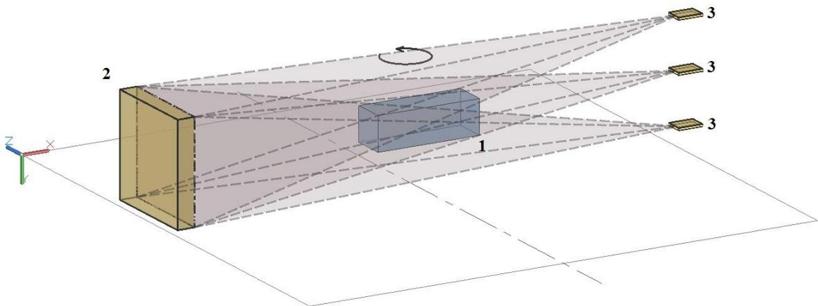
Рисунок 5. Схема экспериментальной установки в избранной системе координат. 1 – исследуемый диэлектрический объект, 2 – РСА, 3 – 3 приемные антенны. Пунктиром отмечены области видимости для пар антенная решетка-приемник.
