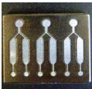
Рисунок 3.10 – Изображение мастер-формы из стали 40Х13, изготовленной методом лазерной гравировки (размер 28x22 мм 2 ), высота структур ~150 мкм
