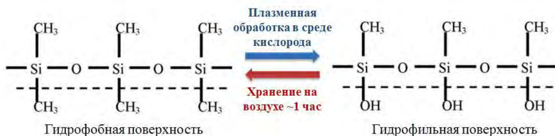
Рисунок 2.7 – Образование функциональных групп на поверхности ПДМС при обработке плазмой в среде кислорода
