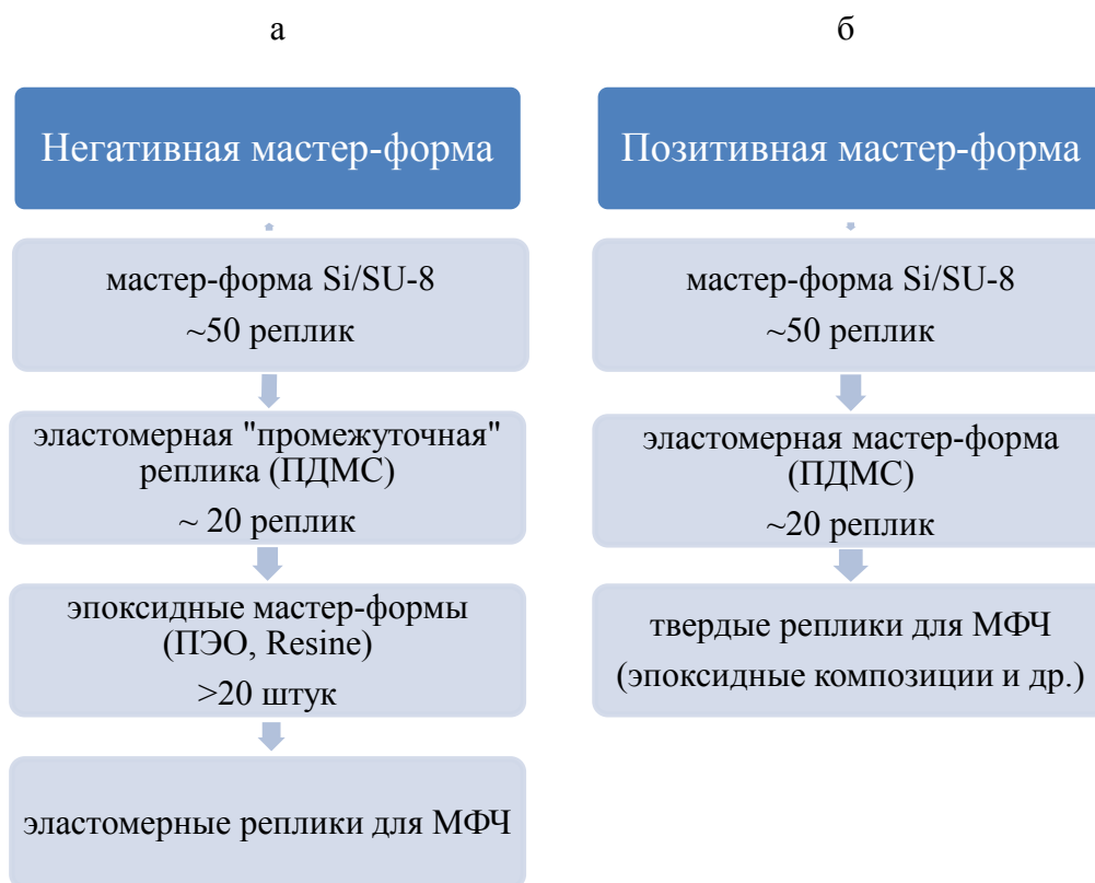
Рисунок 3.1 – Стадии изготовления отпечатков структур для МФЧ из эластомерных материалов и эпоксидных компаундов в зависимости от исходной кремниевой мастер-формы: а – на основе негативного фоторезиста, б – на основе положительного фоторезиста
