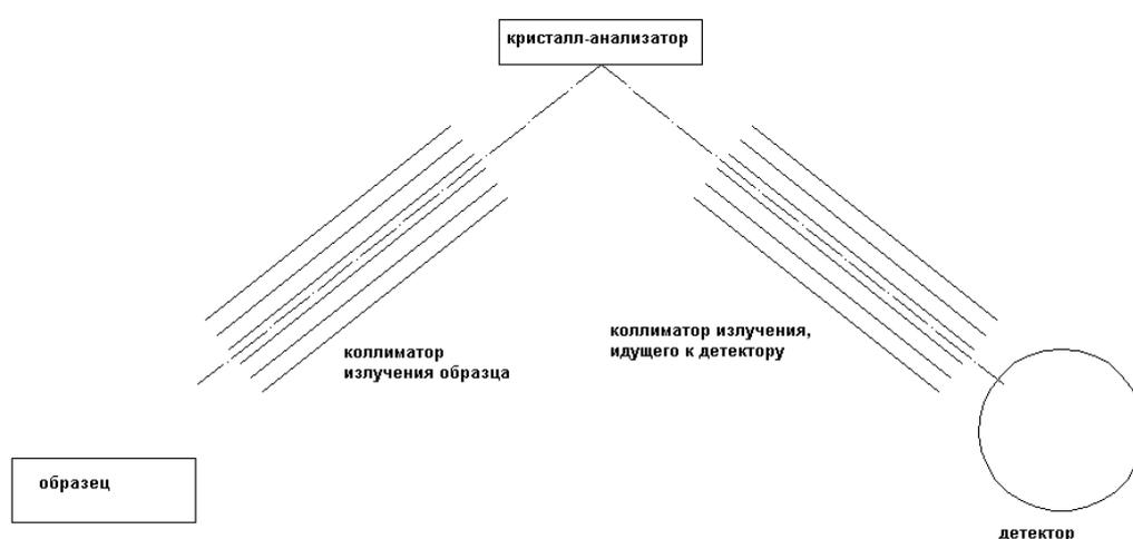
Рис. 1.7. Рентгенооптическая схема по Соллеру.
