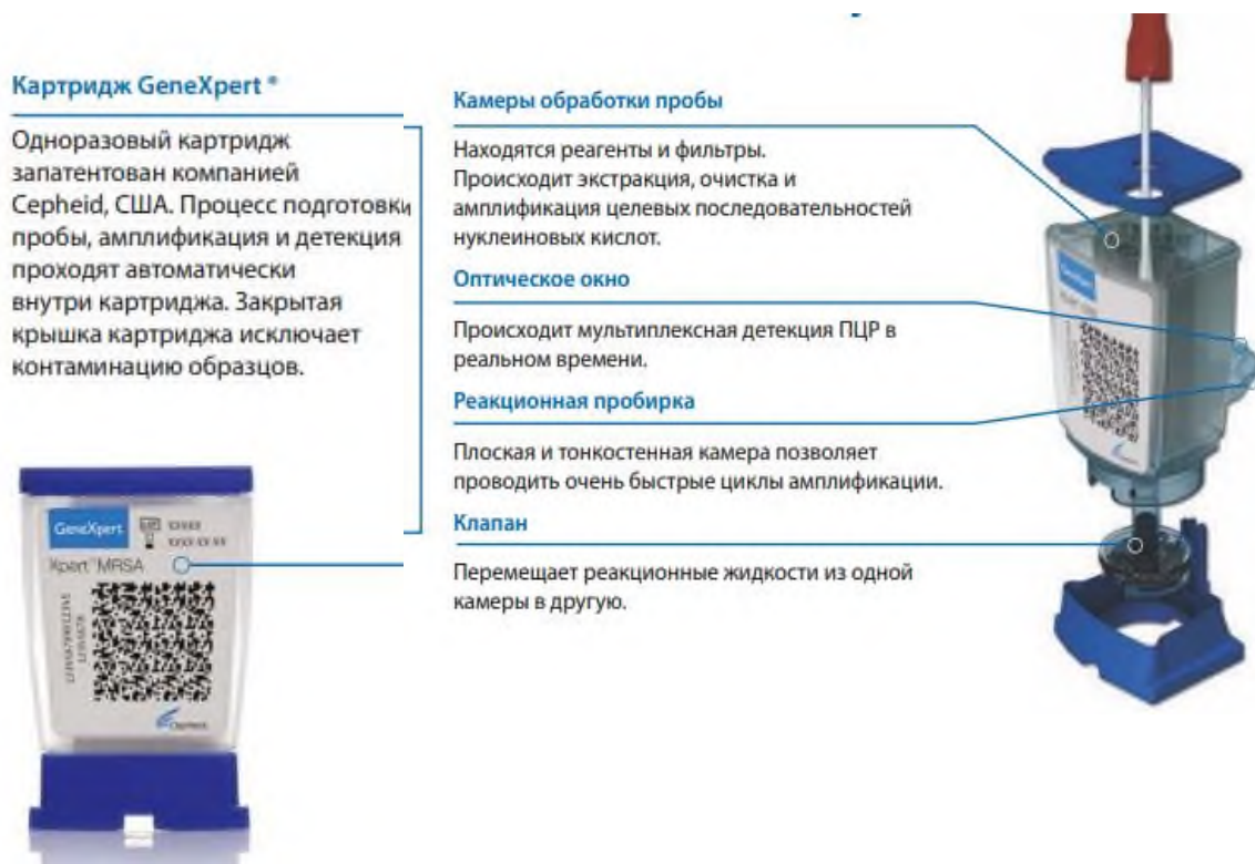
Рисунок 1.6– Одноразовый картридж GeneXpert [122]
