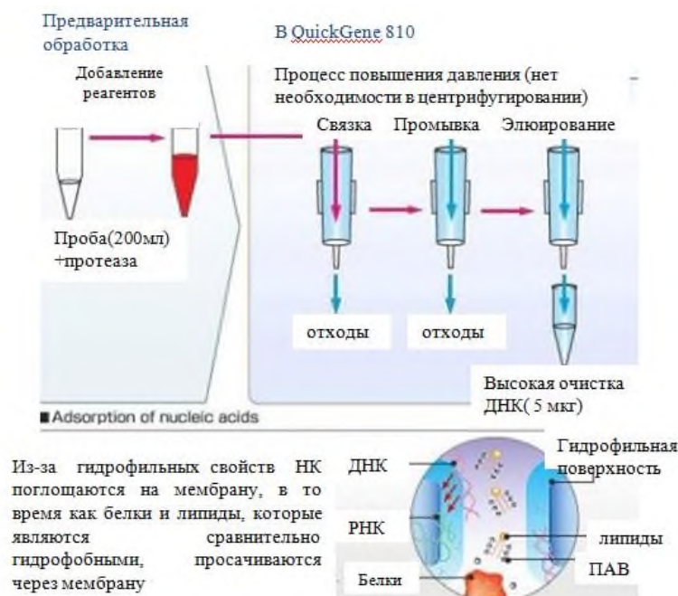
Рисунок 1.1 – Выделение ДНК из крови по технологии AutoGen [111]
