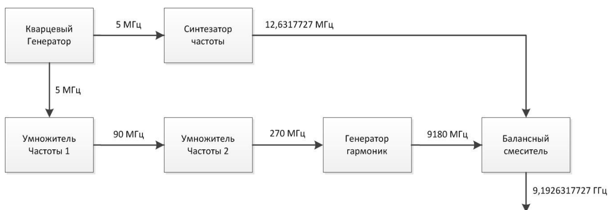
Рис. 2.1. Структурная схема формирования сигнала СВЧ – возбуждения в КСЧ на атомах цезия - 133.
