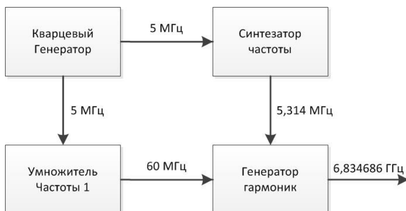
Рис. 2.2. Структурная схема формирования сигнала СВЧ – возбуждения в КСЧ на атомах цезия - 133.
