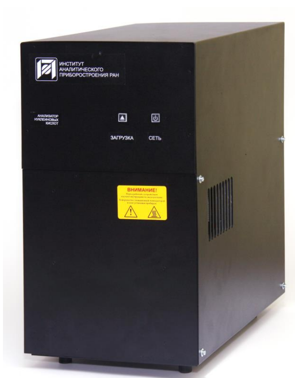
Рис. 36 – АНК-96 (96 образцов, 8 каналов регистрации флуоресценции)
