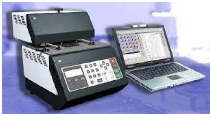
Рис. 33 – АНК-16 (16 образцов, 4 канала регистрации флуоресценции) АНК-32 (32 образца, 5 каналов регистрации флуоресценции)
