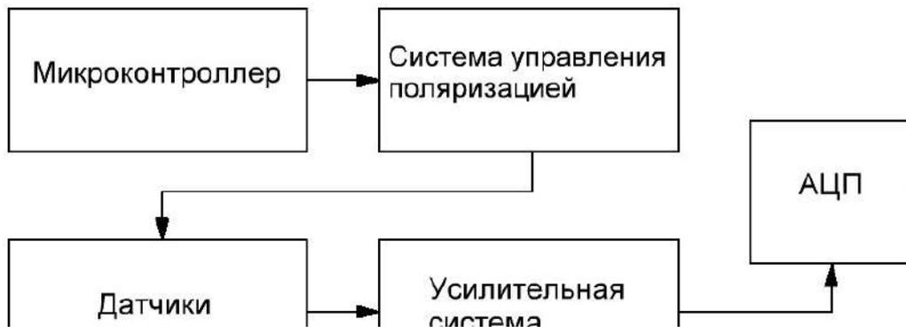
Рисунок Б.1 – Блок схема релаксационного магнитометра
