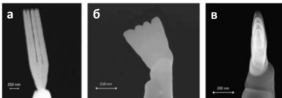
Рисунок 4.2. СЭМ изображения 2D углеродных наноструктур, сформированных под действием сфокусированного электронного пучка, в виде нановилки (а) и наноплоскости: вид сбоку (б) и профиль (в).
