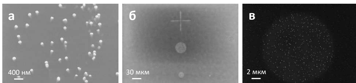
Рисунок 6.19. (а) СЭМ изображение GaN ННК на Si подложке, частично закрытых (не на полную длину ННК) резистом SU-8 – изометрический вид. (б, в) СЭМ изображения сформированных мез со счетными количеством вскрытых ННК в SU-8 – вид сверху.
