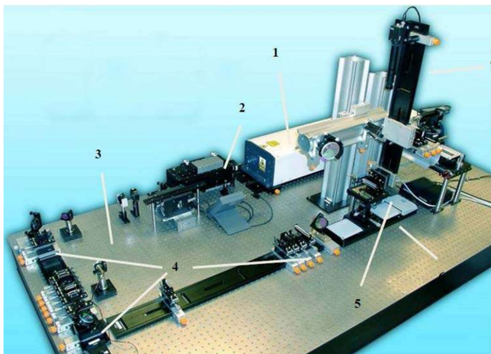
Рисунок 1.10 – Основные узлы системы исследования биообъектов: 1 – диодный лазер; 2 – аттенюатор; 3 – оптический стол; 4 – элементы оптической системы; 5 – столик для подложек; 6 – система приводов столика; 7 – видеокамера.
