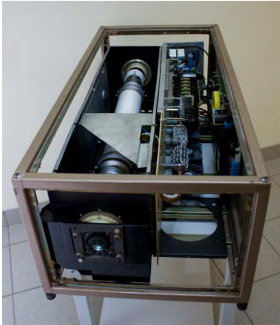
Рисунок 2.8 – Фотография лазер на парах меди со снятыми стенками экранирующих кожухов.
