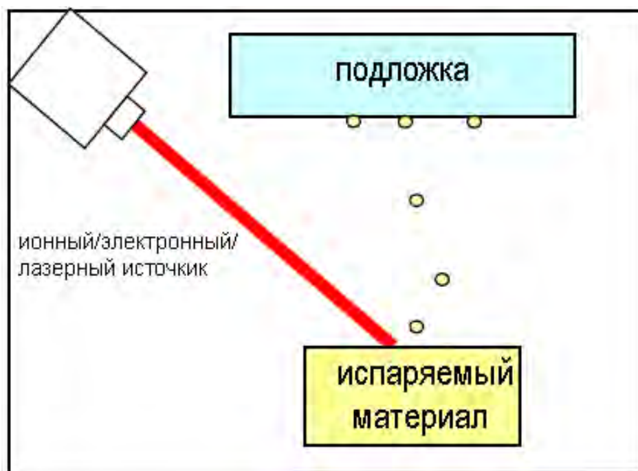
Рисунок 1.9 – Схематическое изображение физического осаждения из газовой фазы частиц на поверхность образца.
