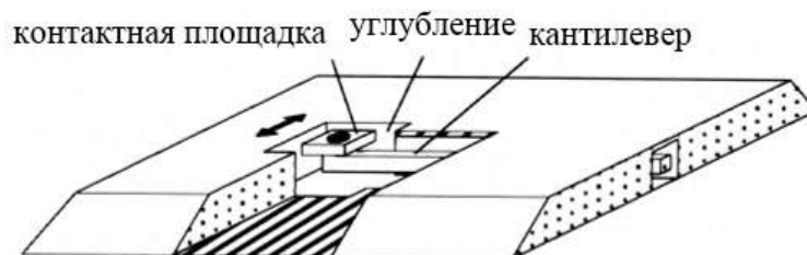
Рисунок 1.4 - Схема устройства датчика силы [34].
