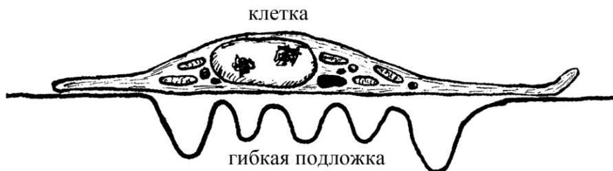
Рисунок 1.3 - Деформирование гибкой подложки за счет движения клетки [33].
