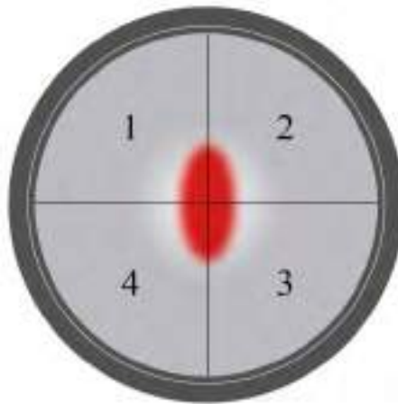
Рисунок 2.1 - Схематичное представление четырехсекционного фотодетектора (пятно от лазерного луча обозначено красным цветом).
