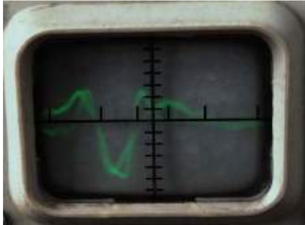
Рисунок 16 – изменение полярности сигнала ЯМР на экране осциллографа.
