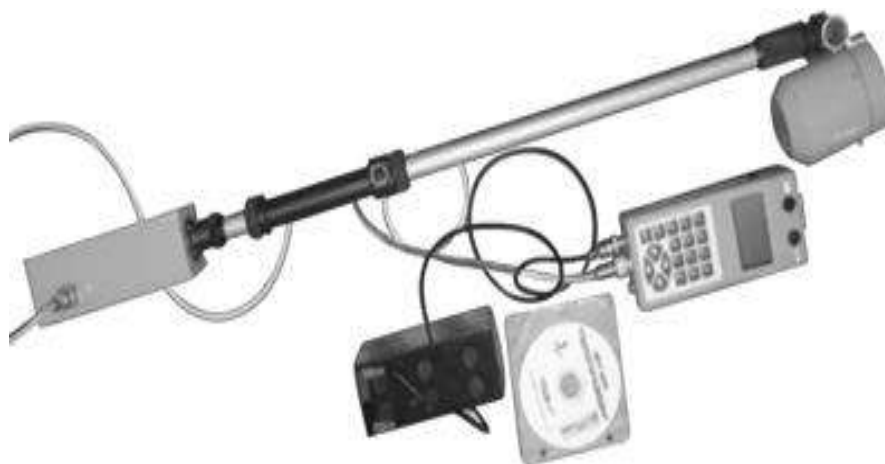
Рис. 2.11 Калиевый магнитометр ПКМ – 1С с модулем интеграции данных.
