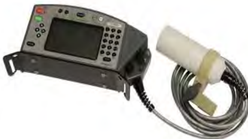
Рис. 2.4 Высокочувствительный магнитометр на основе паров цезия MagMapper G – 858.
