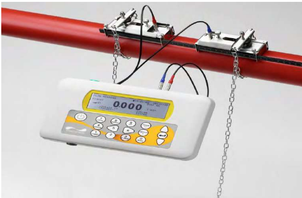
Рис. 1.7 Внешний вид и схема крепления накладного ультразвукового расходомера.
