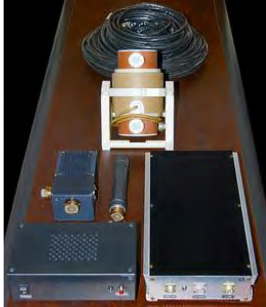
Рис. 2.10 Калиевый магнитометр на изолированной узкой линии.
