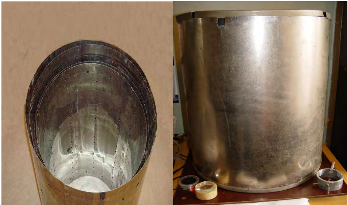
Рис. 5.6 Внешний вид ферромагнитного экрана для цезиевых магнитометров. Коэффициент экранирования более 10^4 .
