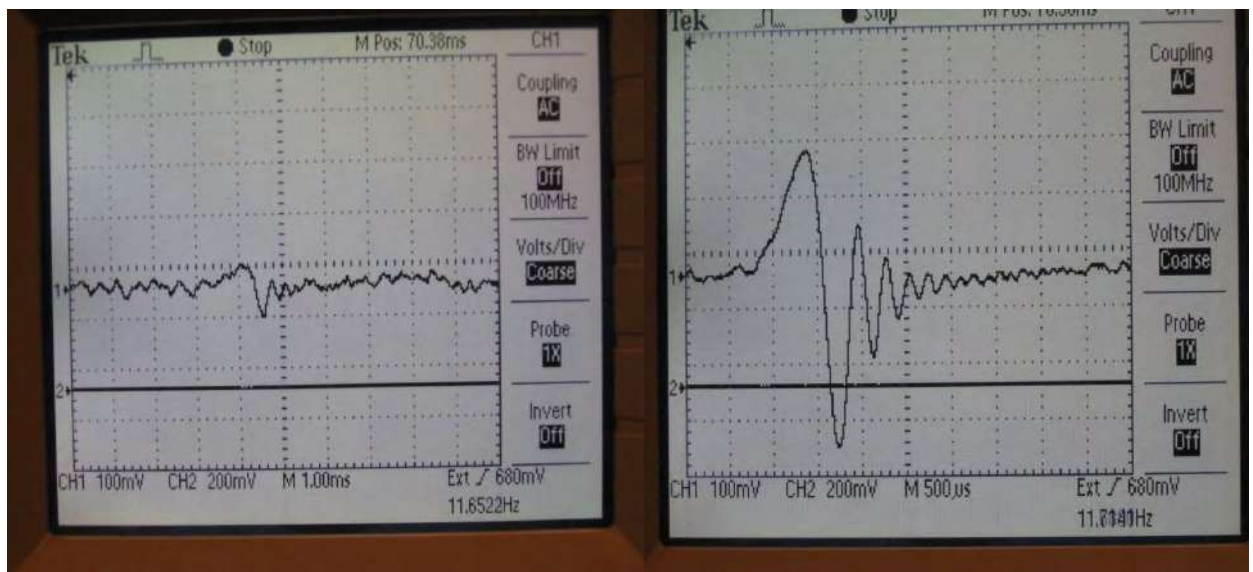
Рис. 6.7 Регистрируемый сигнал ЯМР от моторного масла: а) - без накопления; б) - на выходе схемы накопления.
