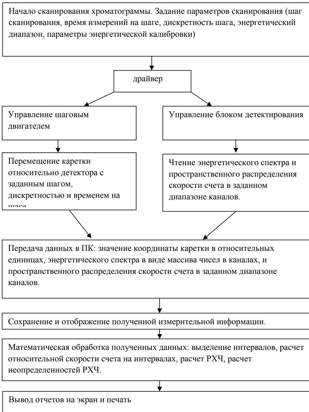
Рисунок 3.8 – Алгоритм измерений хроматограммы
