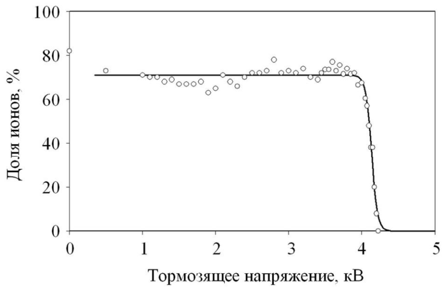
Рисунок 7.4. Пропускание анализатора в зависимости от потенциала тормозящего электрода.
