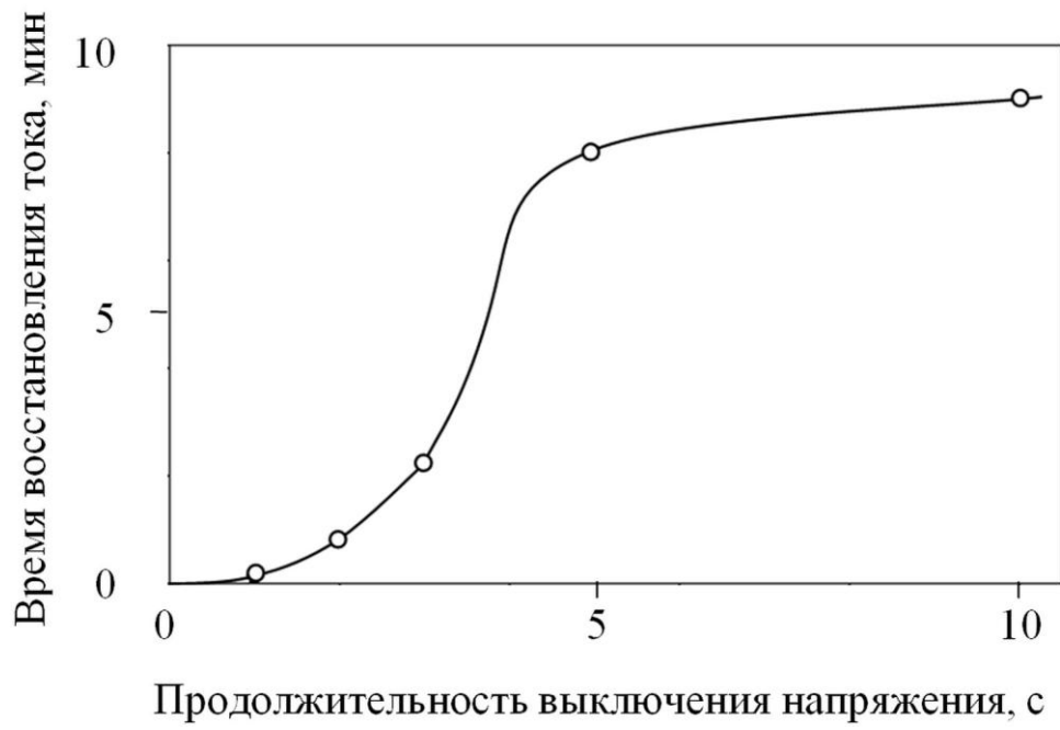
Рисунок 3.8. Зависимость времени восстановления тока от длительности выключения напряжения, стимулирующего выход ионов из глицерина.
