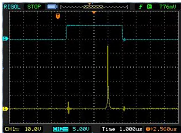
Рисунок 7.26. Осциллограммы напряжения экстрагирующего (внизу) и ускоряющего (вверху) импульсов. Развертка по горизонтали – 1 мкс в делении сетки.
