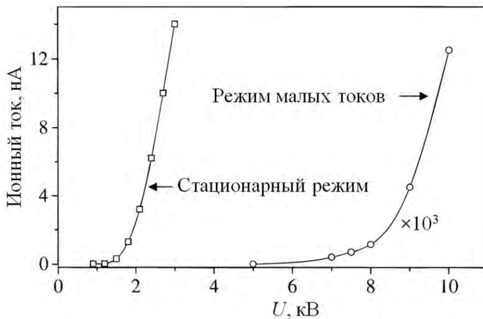
Рисунок 3.4. Типичные зависимости тока отрицательно заряженных ионов, экстрагируемых из каналов трековой мембраны, заполненных глицерином, от приложенного напряжения в переходном режиме малых токов и в стационарном режиме. Зазор между мембраной и плоскостью сетчатого электрода – 0,4 мм.
